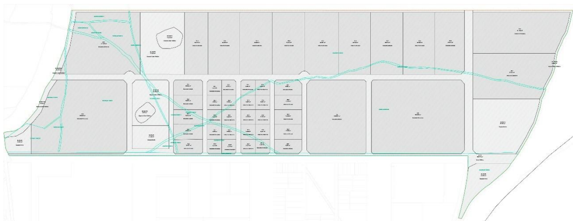
Ilustración 35. Superposición entre la parcelación catastral existentes y la parcelación propuesta por el Plan Regional
