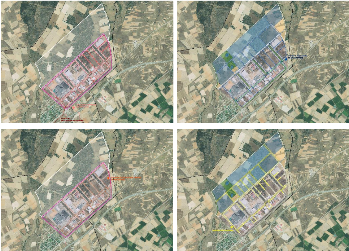
Ilustración 22. Esquema de las redes y conexiones existentes en el entorno: saneamiento-pluviales; abastecimiento; gas; electricidad
